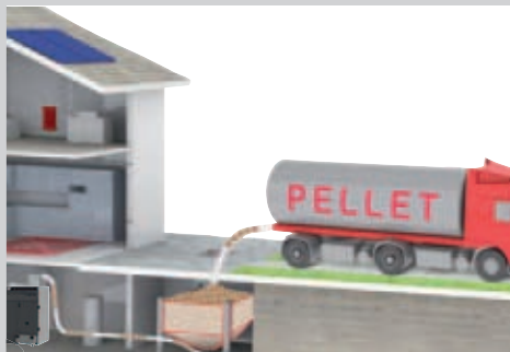
Пример загрузки пеллет из автоцистерны
