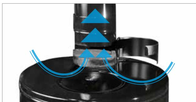
Если в парилке отсутствует вентиляционное отверстие, помещение можно проветрить, закрыв лючок для поддавания пара и открыв клапанный затвор дымовой заслонки. Дымовая заслонка в это время должна быть закрыта (нижний рисунок). Таким же способом можно высушить помещение после того, как банные процедуры закончены.
